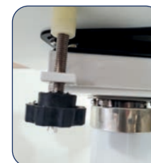
Système de blocage plateau tournant
